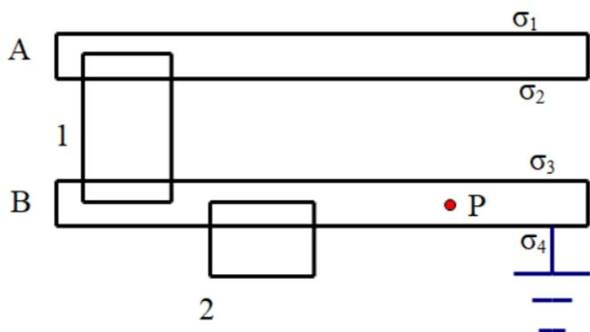
取如图1, 2两个高斯面。由于下极板接地，故下极板以下无电场，又导体内部没有电场。由高斯定理得：
