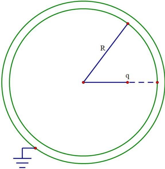
由于静电屏蔽, 球壳外无电场, 球壳内表面带上总和为 $-q$ 的电荷。故有:
